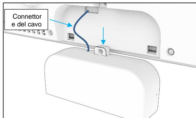
2. Rimuovere la vite di montaggio dal coperchio in alto a destra del display IDS e far scorrere il coperchio in basso per sganciare i ganci di montaggio.
