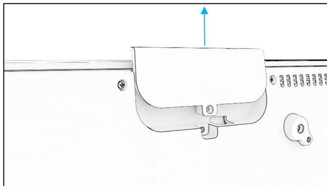
3. Installare l'altoparlante nella nuova posizione collegando il connettore del cavo dell'altoparlante. Quindi inserire il cavo e il connettore attraverso il foro e far scorrere l'altoparlante dall'alto in basso in modo che entrambi i ganci siano agganciati alle fessure nel coperchio posteriore. Reinstallare la vite di montaggio.
