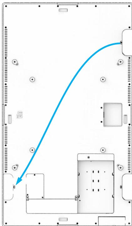
1. Rimuovere la vite di montaggio dell'altoparlante e farlo scorrere in basso per sganciare i ganci di montaggio. Tirare l'altoparlante verso il basso in modo che il connettore del cavo sia visibile e sganciare il connettore.
