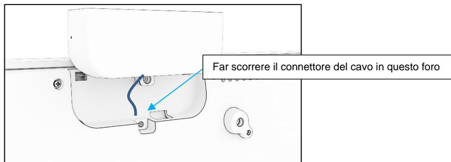
4. Installare il coperchio rimosso al punto 2 nella posizione dell'altoparlante precedente facendolo scorrere in modo che i ganci si innestino nelle fessure del coperchio posteriore e quindi installare la vite di montaggio.
