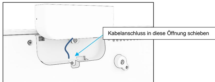
4. Installieren Sie die in Schritt 2 entfernte Abdeckung an der alten Lautsprecherposition, indem Sie sie so hineinschieben, dass die Haken in den Schlitz in der rückseitigen Abdeckung greifen. Installieren Sie dann die Montageschraube.
