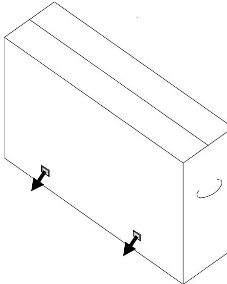
3. Sobald die Riegel entfernt sind, können Sie den oberen Deckel des Kartons vom unteren Rahmen abheben.
