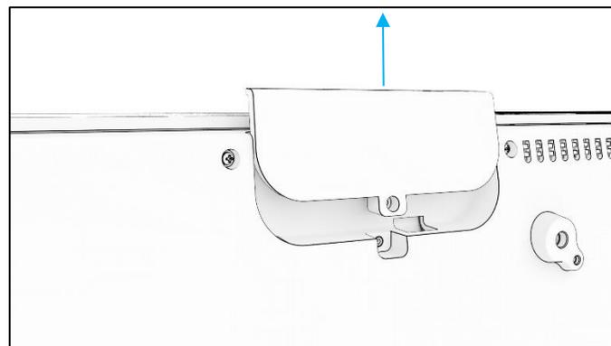
3. Installieren Sie den Lautsprecher an der neuen Position, indem Sie den Anschluss des Lautsprecherkabels anschließen. Stecken Sie dann Kabel und Anschluss durch die Öffnung und schieben Sie den Lautsprecher von oben nach unten, sodass beide Haken in den Schlitz in der rückseitigen Abdeckung greifen. Bringen Sie die Montageschraube wieder an.
