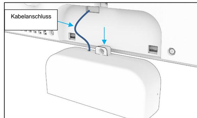
2. Entfernen Sie die Montageschraube von der Montageabdeckung oben rechts am IDS-Display und schieben Sie die Abdeckung zum Lösen der Montagehaken nach unten.
