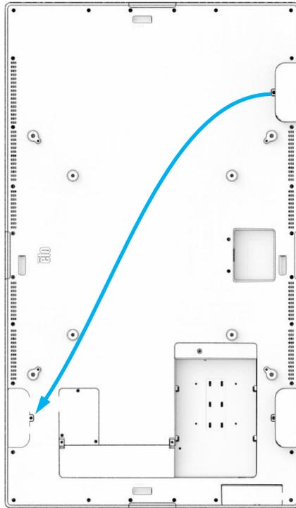
1. Entfernen Sie die Montageschraube des Lautspeakers und schieben Sie den Lautsprecher zum Lösen der Montagehaken nach unten. Ziehen Sie den Lautsprecher weit genug nach unten, sodass der Kabelanschluss freiliegt, und lösen Sie den Anschluss.
