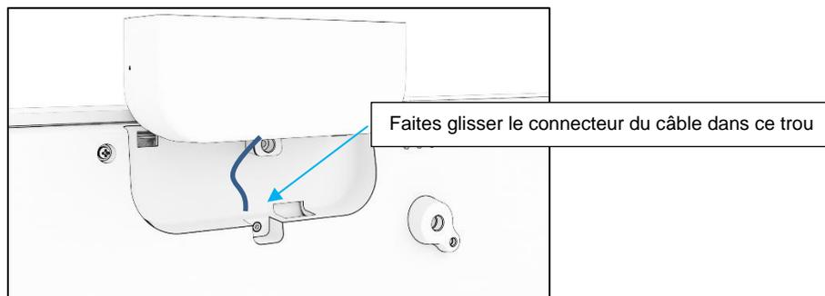
4. Installez le couvercle qui a été retiré à l'étape 2 à l'emplacement de l'ancien haut-parleur en le faisant glisser pour que les crochets s'engagent dans les fentes du couvercle arrière, puis remettez la vis de fixation.
