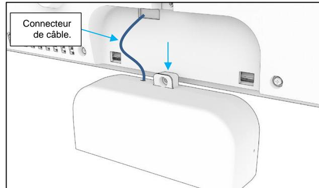
2. Retirez la vis de fixation du couvercle de montage en haut à droite de l'écran IDS et faites glisser le couvercle vers le bas pour dégager les crochets de montage.
