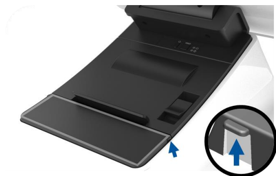
图5。当出现卡纸问题时，可对侧面凸条(蓝色箭头)施加向上压力将卡纸的打印机门打开(浅灰色)
