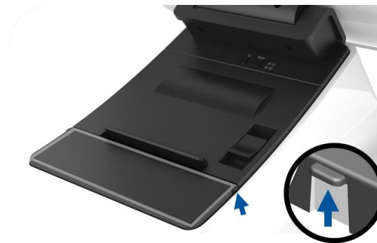
図 5. 紙詰まりが発生した場合は、サイドリブ（青色の矢印）を押し上げ、紙詰まりプリンタードア（淡い灰色）を開きます
