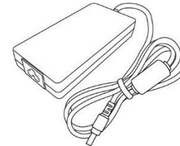
Adaptador de alimentación de +24 V
